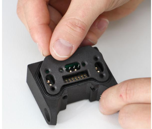
Sebbene sia il PA11 ad alto rendimento che il PA12 siano adatti per i connettori, in questo caso specifico era possibile applicare SAF™ PA12, in quanto mostra rigidità e precisione migliorate. In confronto, il PA11 è caratterizzato da un'eccellente resistenza agli urti e dalla duttilità, per applicazioni che subiscono carichi più dinamici.
