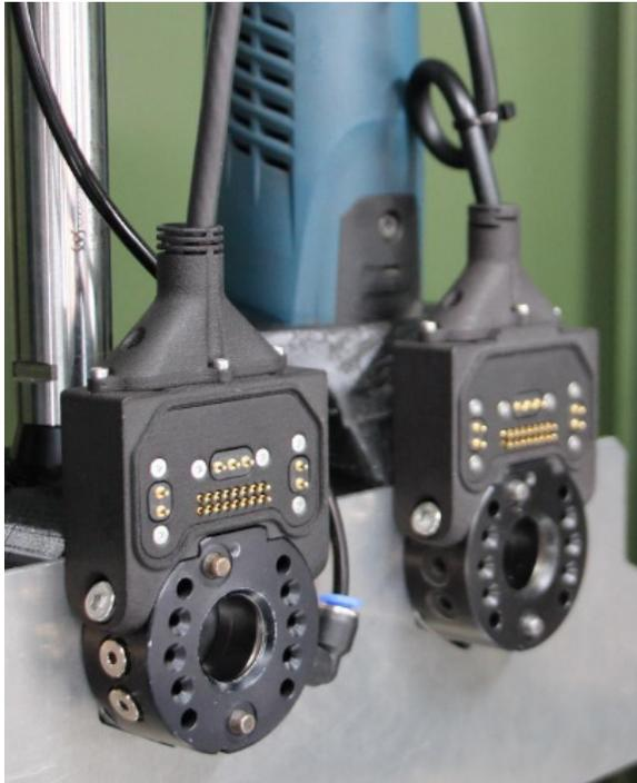
È fondamentale che il connettore possa essere utilizzato su vari strumenti e che resista a correnti elevate. Ogni pin di alimentazione ad alta corrente può richiedere fino a dieci ampere. I pin di dati a corrente inferiore sono in grado di far passare in modo affidabile un ampere ciascuno.
