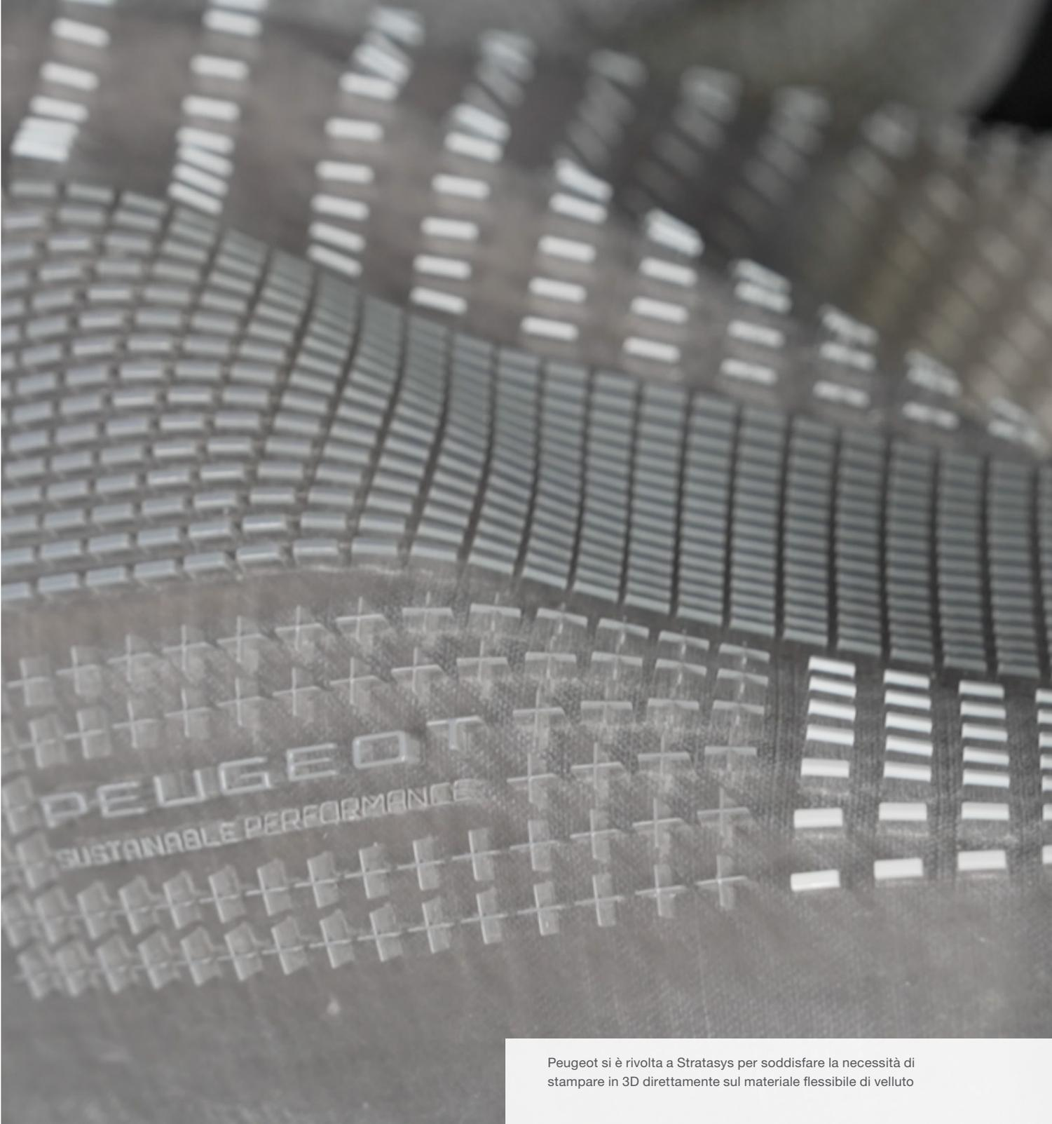
Peugeot si è rivolta a Stratasys per soddisfare la necessità di stampare in 3D direttamente sul materiale flessibile di velluto
